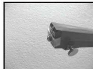
Отрежьте свободные концы струны и наклейте тефлоновую ленту.
