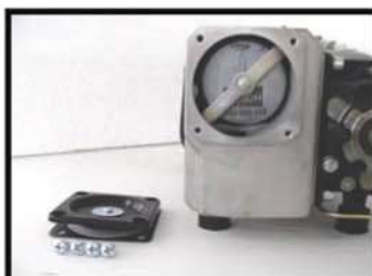
Фильтр(ы) расположен под прижимной пластиной
