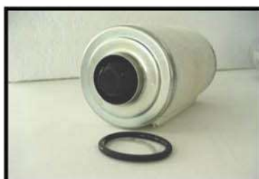
Убедитесь, что прокладка фильтра не осталась в камере после извлечения фильтра
