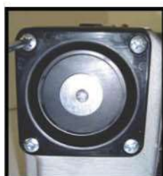
Снимите крышку камеры воздушного фильтра
